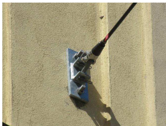
Obr. 63: Horizontální kardan s parafilem
