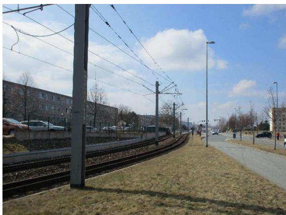
Obr. 1: Řetězovkové trolejové vedení tramvajové tratě
